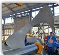
**3)** O eixo de cada rolo lateral é controlado independentemente, permitindo pequenos ajustes na posição do rolo, tornando também desta forma a calandragem do Cone extremamente fácil de executar.
