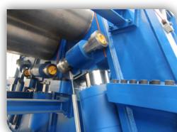
**1)** A força dos Rolos Laterais ou de conformação é transmitida diretamente para o cilindro hidráulico e portanto para o montante e para a fundação da Calandra Hidráulica. Desta forma, as cargas diretas sobre as chumaceiras são anuladas e é também anulado o efeito de torção que afeta o paralelismo dos rolos. A precisão do "paralelismo" dos rolos laterais é assegurada, proporcionando maior longevidade dos componentes e baixa manutenção mecânica.
