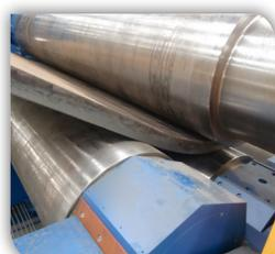
**2)** A distância reduzida entre o centro do rolo lateral e o centro do rolo superior assegura que a Ponta Recta relacionada com a Pré-calandragem será reduzida e consistente.
